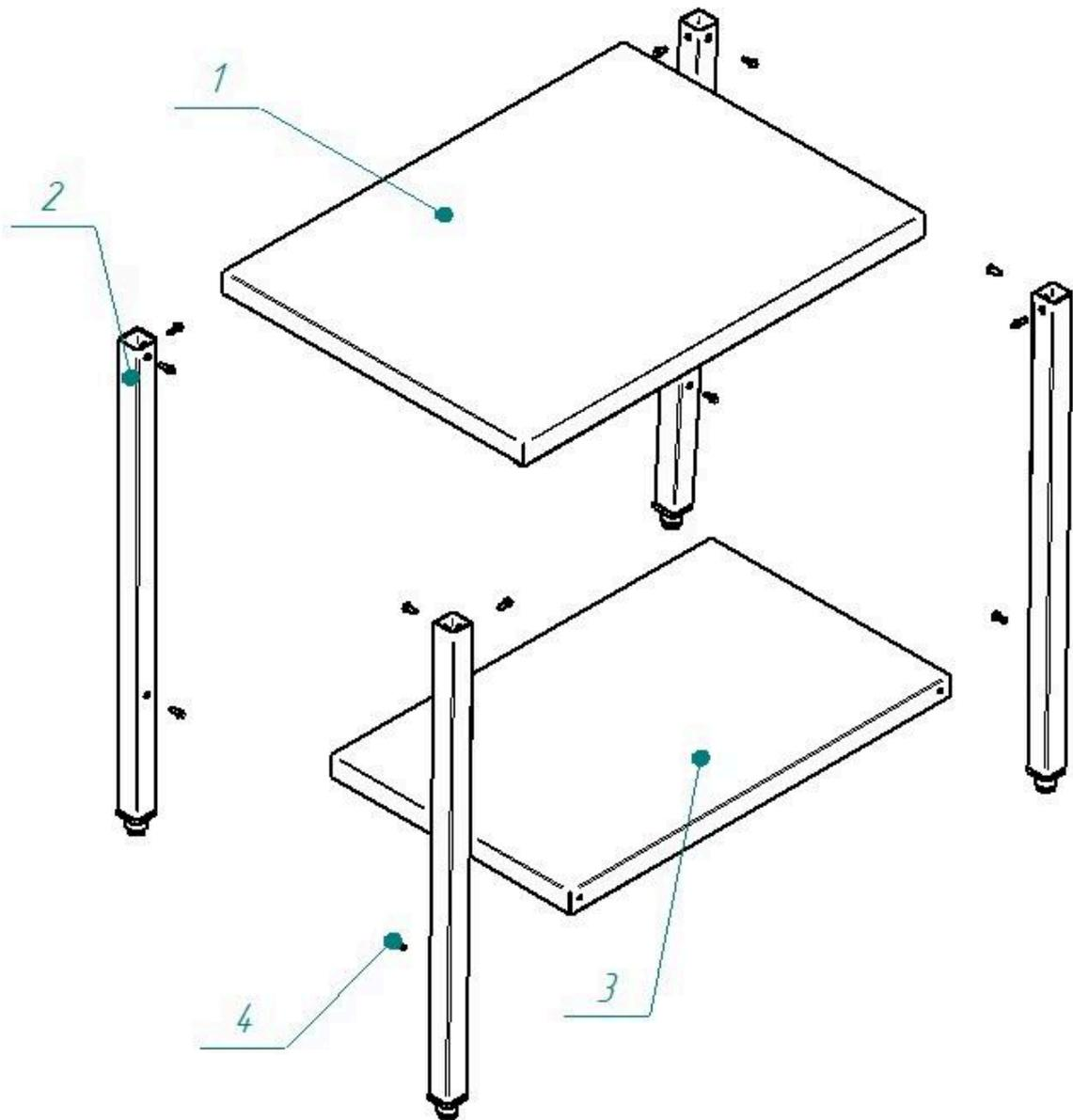
Рис. 1б схема сборки столов из нержавеющей стали.
